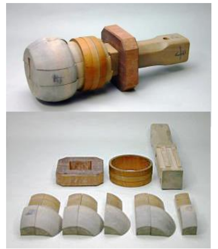
木型1式部品抜き取りながら型を取る
